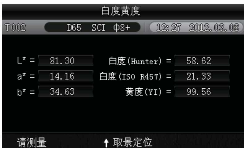
图 41 L*a*b* 白度 黄度 测量界面
