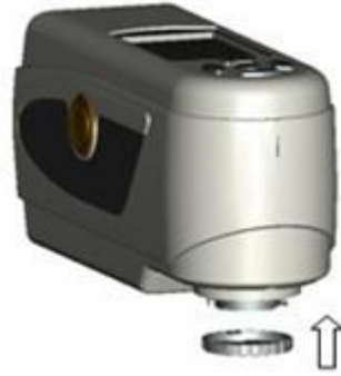
图 10 测量口径对准安装孔位
