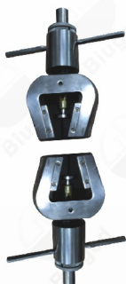
BGD 1702 锻形夹具 (金属用, 不适合BGD 575)
