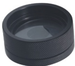
粉末测试盒: 适合测量粉末状物体
